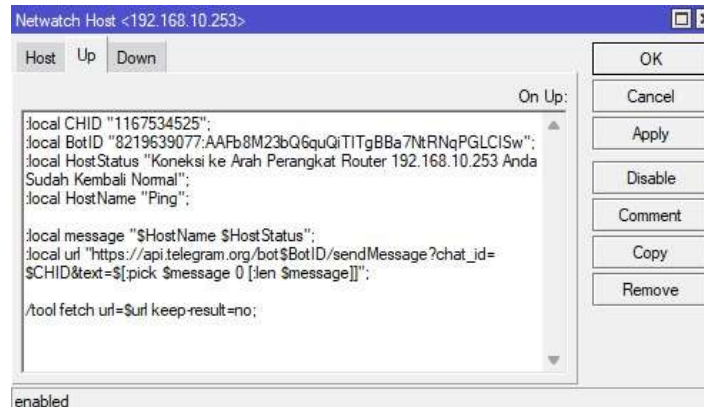
Gambar 9 Konfigurasi Alert Telegram pada Mikrotik
